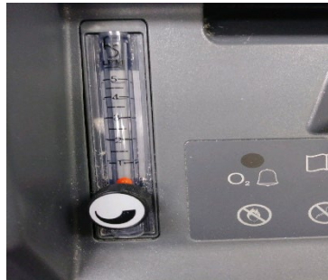
Perilla de flujo que regula los litros de oxígeno en un concentrador
